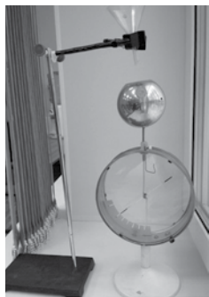
Рис. 7. Результаты замера электризации песка с помощью электрометра
