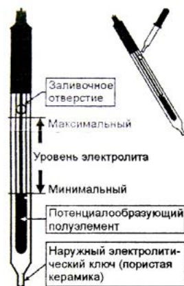
Рис. 3. Проверка уровня электролита в электроде сравнения
